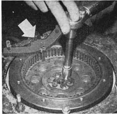
PHOTO 56 : Emploi de l'outil de blocage du volant-moteur (Photo RMT)
