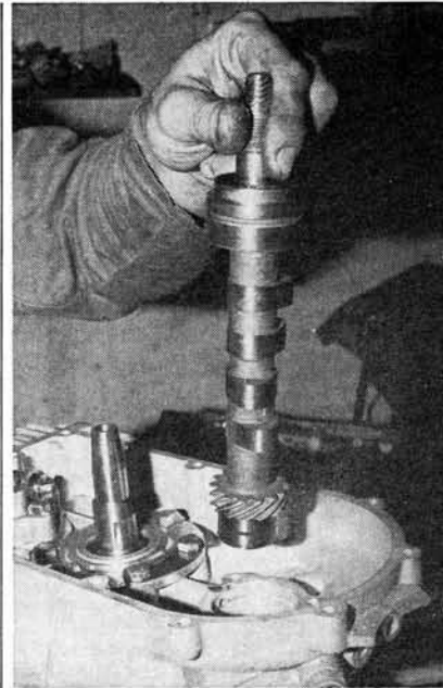
PHOTO 43 : Dépose de l'arbre à cames (Photo RMT)
