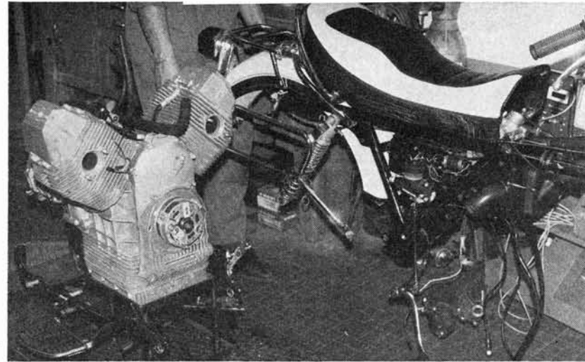
PHOTO 49 : Séparation moteur-cadre (Photo RMT)
