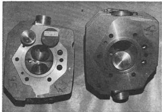
Culasses équipées de soupapes Ø 51 et 43 mm (Photo RMT)
