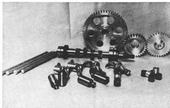
Kit de distribution avec pignons en Ergal, culbuteurs polis montés sur aiguilles et poussoirs rallongés (Photo Ch. Krajka)
