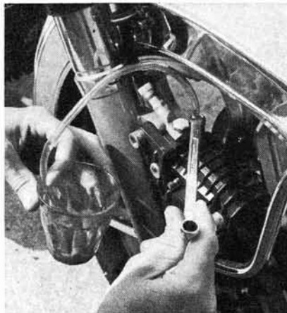
PHOTO 27 : Purge du liquide de frein (Photo RMT)
