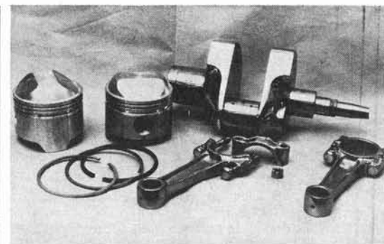
Pistons haute compression, bielles et vilebrequin polis (Photo Ch. Krajka)
