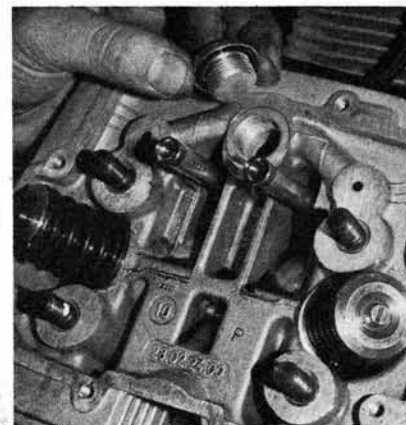
PHOTO 32 : Bou- chon masquant la vis six pans creux (Photo RMT)
