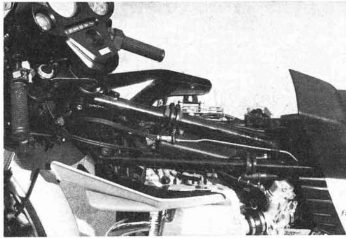
Sur cette photo, on peut voir la canalisation de liquide de frein qui joint le « répartiteur » de freinage à l'étrier avant gauche (Photo RMT)
