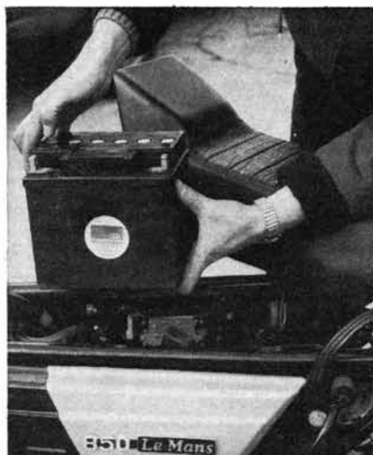
PHOTO 17 : Dépose de la batterie (Photo RMT)
