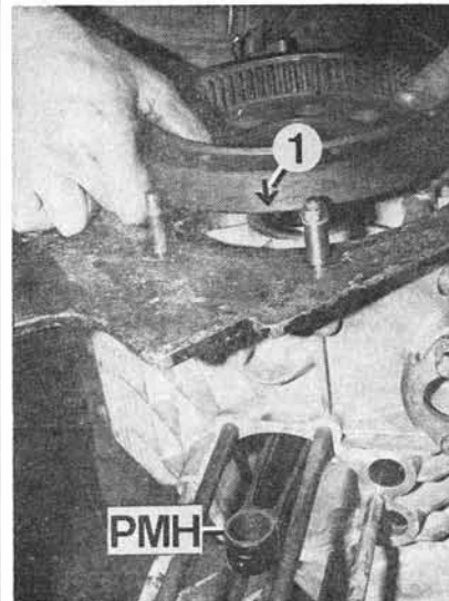
PHOTO 58 : La flèche (1) doit être dans l'axe de la bielle au P.M.H. (Photo RMT)
