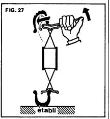
Rabattre le 2º levier vers le moyeu de la roue en maintenant le premier en place. - Dégager le 2º levier lorsque le talon du pneu est passé par dessus le rebord supérieur de la jante.
