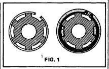
Sur un arbre cannelé (fig. 1), l'ouverture du circlip doit être positionnée au-dessus du creux d'une cannelure.
