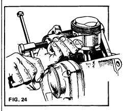
remontage chauffer également le piston. à la flamme douce ou mieux dans de l'eau bouillante, ou dans de l'huile chaude si l'on doit chauffer à plus de 100° C.
