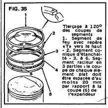
Les constructeurs préconisent un tiercage à 120° (fig. 35) ou un tierçage à 180° (fig. 36). Sur ces figures est également illustré le repérage du sens de montage des segments.
