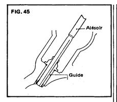
Dans ce cas, il est nécessaire d'aléser le logement du guide au Ø prescrit.
