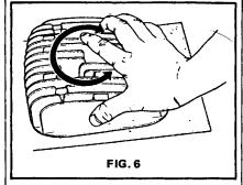
Si le défaut est trop important, sans toutefois excéder plusieurs 1/10 de mm. confier la culasse à un atelier de mécanique pour une rectification. Les constructeurs indiquent parfois la hauteur minimale de la culasse en dessous de laquelle il ne faut pas descendre (compression excessive, ou piston venant cogner).
