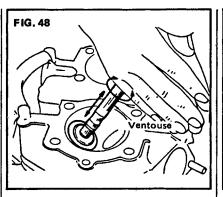
• A l'aide d'une ventouse à roder, tourner la soupape sur son siège, par un mouvement alternatif des mains (fig. 48). • Le rodage est terminé dès que l'état de surface est lisse et régulier. Après rodage, nettoyer soigneusement
