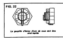
Dans certains cas (axes de roues notamment) ces goupilles peuvent être avantageusement remplacées par des goupilles type Bêta ainsi appelées du fait de leur
